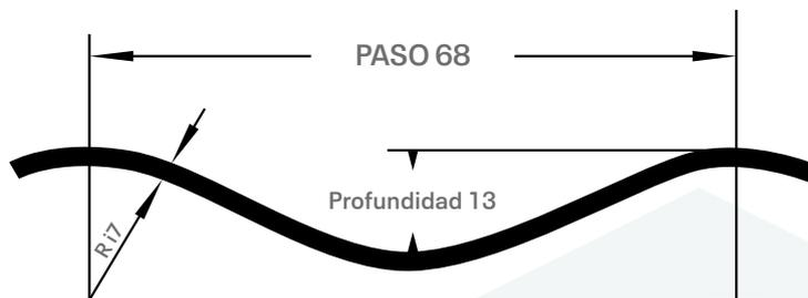
**Figura 1. Dimensiones de la corruga 68 mm x 13 mm**
